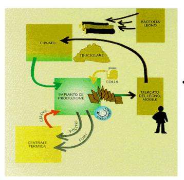
schema utilizzo residui della lavorazione del legno per la produzione di energia termica
